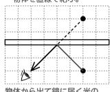
物体から出て鏡に届く光の 道筋を作図する。
